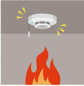
2006年から新築住宅への設置が義務化された「住宅用火災警報器」。煙式と熱式があり、寝室や階段、台所に設置して火災を早期発見します。電池式と配線式があり、10年を目安に交換が推奨されています。初期消
